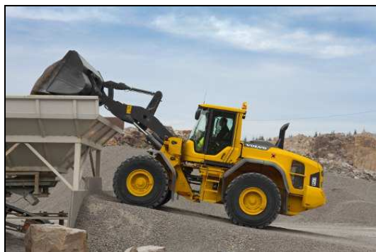
Figure 14 : Exemple de chargeuse sur pneus
