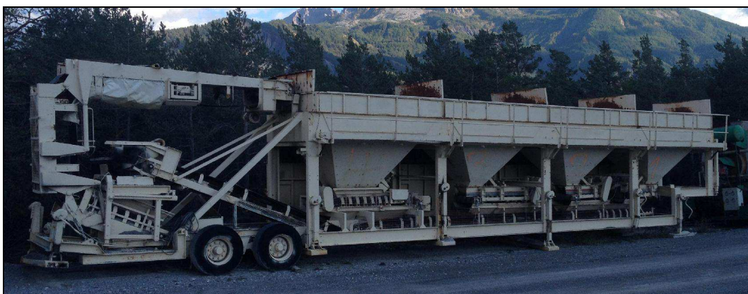
Figure 6 : Exemple de trémies de granulats
